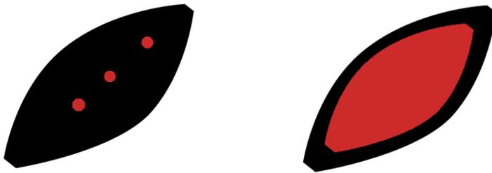
Kommt man also zu dem Entschluss, dass das Aussparen nötig ist, muss man eine der beiden Folien überfüllen. Welche von den beiden ist eigentlich klar: die, die zuerst geklebt wird. Doch da man selbst meist nicht weiß, welche der beiden Farben als erstes geklebt wird, sollte man auch hier den Plottbetrieb fragen. Meistens wird allerdings die große Fläche zuerst geklebt, doch das ist, wie gesagt, Sache des Plottbetriebes.
